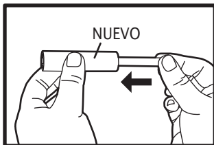
Coloque el eje metálico en el nuevo rodillo de limpieza
